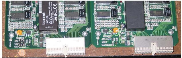
THIS PHOTO SHOWS LOCATION OF OPTO AND JUMPER ON KAI-16 MODULE (LEFT) AND KDI-16 (RIGHT)
